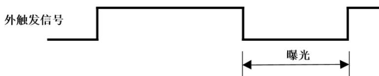
图 8-31 下降沿触发宽度曝光模式时序图
